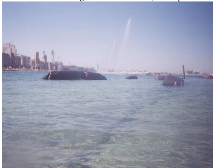
Galleggianti sgonfi e danneggiati
